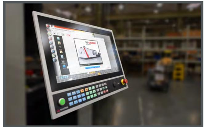
*Die Vielseitigkeit des MOSAIC+ Bildschirms ermöglicht dem Bediener die gleichzeitige Ansicht mehrerer Maschinenfunktionen und zugehöriger Geräte, wie z. B. der Heißkanalsteuerung und fernmontierter IP-Kameras.*
