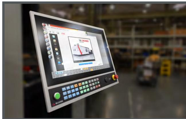
La versatilità dello schermo MOSAIC + consente all'operatore di visualizzare più funzioni della macchina e dispositivi associati come il controllo del canale caldo e le telecamere IP montate a distanza.
