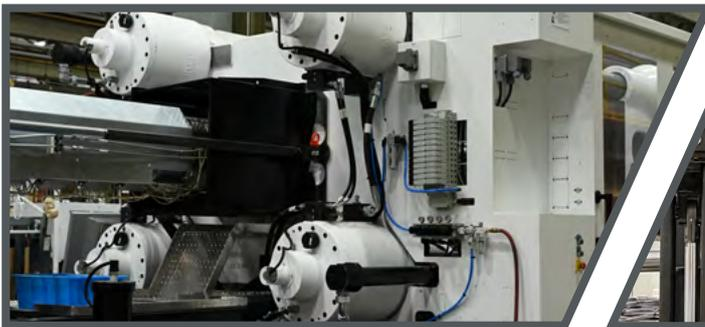
*Traversenzylinder mit Schwenkzapfenbefestigung*
