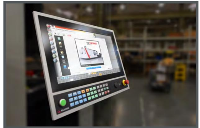
*Die Vielseitigkeit des MOSAIC+ Bildschirms ermöglicht dem Bediener die gleichzeitige Ansicht mehrerer Maschinenfunktionen und zugehöriger Geräte, wie z. B. der Heißkanalsteuerung und fernmontierter IP-Kameras.*
